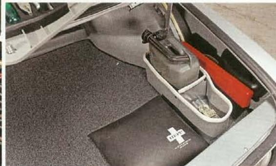
Die Bodenplatten im Kofferraum mussten neu angefertigt und originalgetreu bezogen werden
