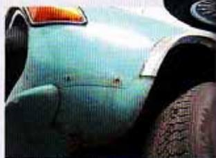
Gern werden Roststellen am Stoß zwischen Frontblech und Kotflügel...
